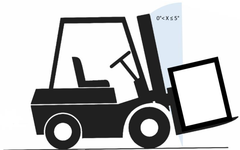
Fig. 9: Vipvinkel for transport med gaffeltruck
