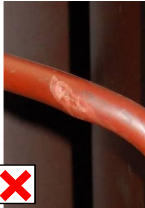
Abb. 11: Nicht zulässig! Deformierte Isolation einer Schaltverbindung
