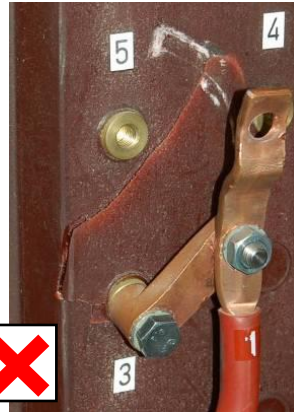
Abb. 12: Nicht zulässig! Aufsplintern von Oberfläche durch Gewalteinwirkung auf Schaltverbindung
