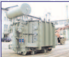
28 MVA 24/1,1 kV OFWF
